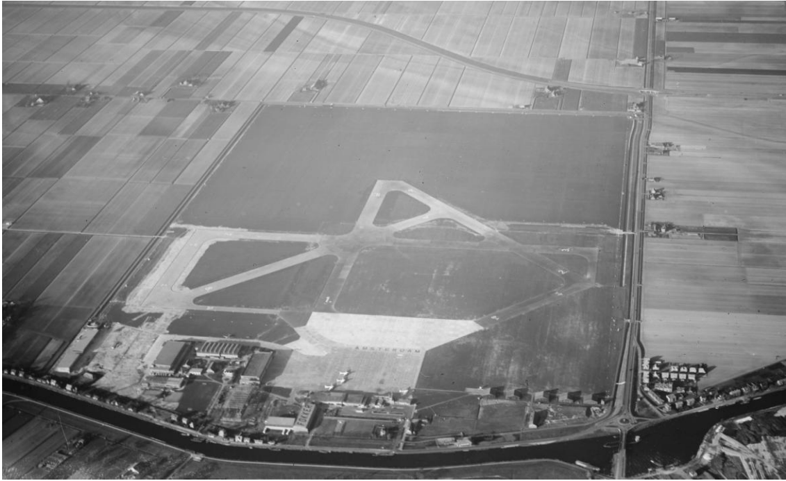
Schiphol in 1939: het betonnen banenstelsel is voltooid en de twee nieuwe militaire hangars uiterst links zijn in gebruik genomen. De nieuw verworven terreindelen zien er ten opzichte van het oorspronkelijke vliegtrein nog maagdelijk uit.
