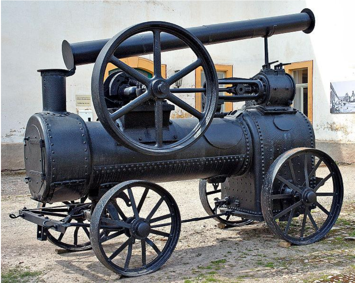
Een lokomobiel type Lanz zoals ook in de kazerne van Schiphol werd gebuikt voor water en stroom.
