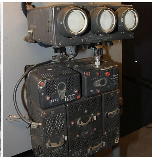
Lichtenstein antennes op de neus van een Junkers 88 jager, rechts de ontvangstinstallatie in de cockpit
