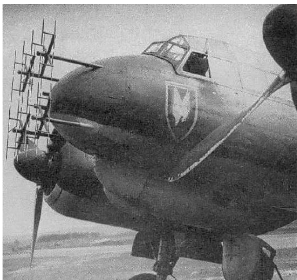
Lichtenstein antennes op de neus van een Junkers 88 jager, rechts de ontvangstinstallatie in de cockpit
